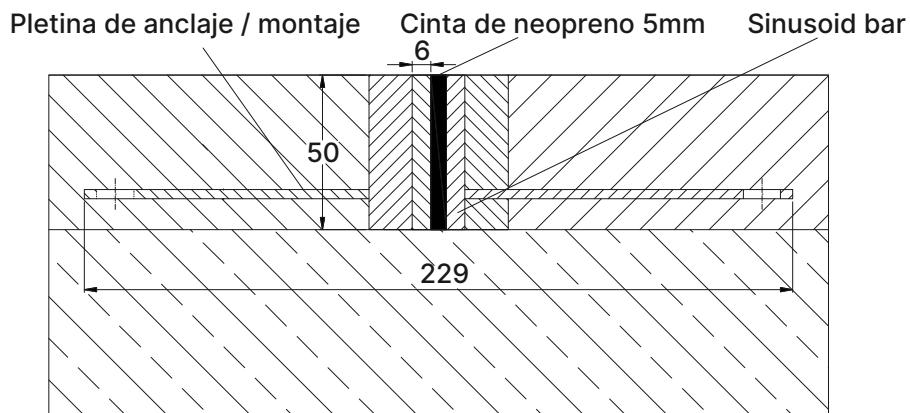
Las juntas Conecto Sinus están diseñadas para reparar grietas en pisos. Su diseño sinusoidal permite el movimiento en dos niveles, evitando que las grietas se profundicen. Una correcta instalación de las juntas Conecto Sinus elimina los daños resultantes y previene daños adicionales. Un piso bien asegurado con juntas Conecto Sinus no causará daños a los vehículos y evitará grietas profundas que podrían impedir su uso posterior. Longitud estándar: 2,4 metros.
