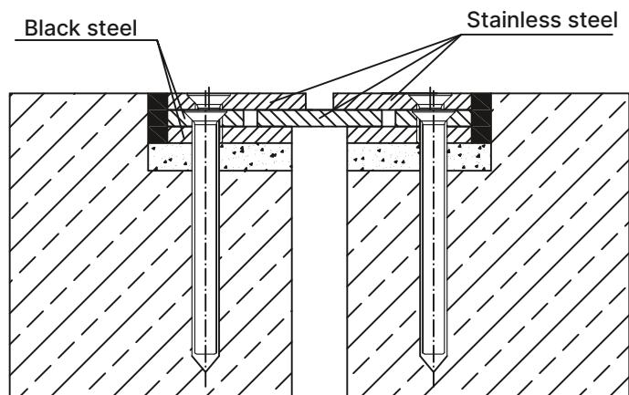
El perfil Conecto 06NC110/18-R está especialmente diseñado para soportar cargas extremas de montacargas y vehículos pesados, además de ser una solución eficaz para la reparación de pisos de concreto agrietados. Gracias a su excepcional capacidad de carga y su funcionamiento sin vibraciones, garantiza durabilidad y confiabilidad a largo plazo.
