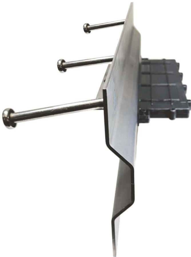
Conecto Omega 03NB se utiliza como solución para los equipos de construcción. Su forma y sistema de pasadores minimizan el movimiento vertical y garantizan una óptima transferencia de carga. Las varillas de tracción aseguran un anclaje sólido en el hormigón durante la contracción producida por el secado, que también provoca la expansión. La superficie superior fresada garantiza una perfecta suavidad de las dos placas de acero y una protección duradera de los bordes del nuevo pavimento.
