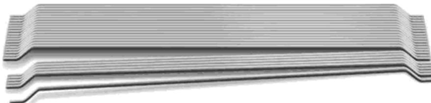
Fibra CF 062-60100 para refuerzo de hormigón, fabricada con alambre de acero estirado en frío con extremos curvados. Aglomerada en haces con adhesivo hidrosoluble. La adición de fibras de acero al hormigón mejoras sus propiedades mecánicas. Gracias a sus elevados parámetros, las fibras CF 062-60100 pueden sustituir las barras de acero de refuerzo convencionales o complementarlas para obtener mejores propiedades del hormigón.
